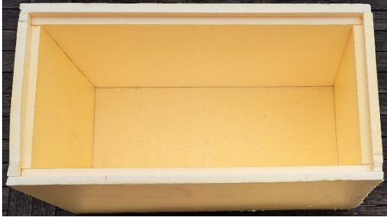
Bild 6: Die Isolierbox aus verklebten XPS-Dämmplatten. Ein passgenau eingesetzter Deckel aus XPS wird später nur mit Klebeband fixiert und bleibt daher abnehmbar.
