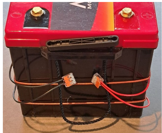
Bild 4: Um die geforderte Heizleistung zu erhalten, habe ich zwei Heizkabelschleifen benutzt und diese parallel geschaltet.
