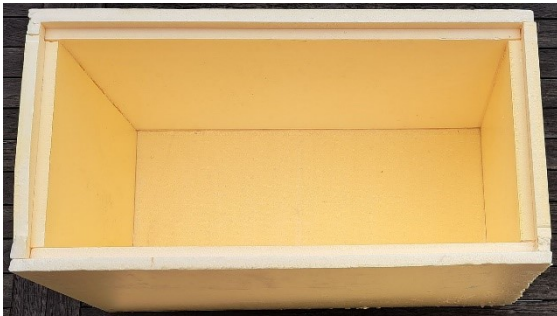
Bild 6: Die Isolierbox aus verklebten XPS-Dämmplatten. Ein passgenau eingesetzter Deckel aus XPS wird später nur mit Klebeband fixiert und bleibt daher abnehmbar.
