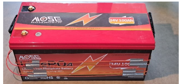
Bild 3: Die Heizkabel werden um den Akkumulator gewickelt und mit Klebeband o.ä. fixiert.
