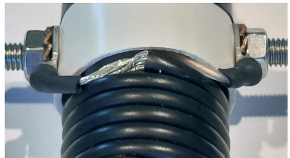
**Bild 12:** Die Leiter des Koaxialkabels werden nur so weit wie notwendig getrennt und mit den Lötäugen verlötet.
