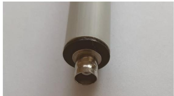
**Bild 14: Detail der Anschlussbuchse für das Funkgerät**
