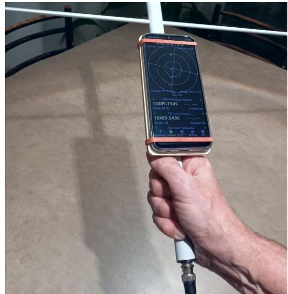
Bild 21: Mit dem montierten Mobiltelefon und der passenden Software wird die Nachführung deutlich einfacher
