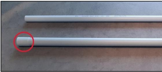
**Bild 7:** Das Material für den Boom ist ein 20 mm PVC-Rohr (oben), die Strahlerhalterung stammt aus dem verdickten Ende eines 25 mm Rohres (Markierung unten links).
