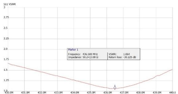
**Bild 18:** Messung des SWV für das 70 cm Band
