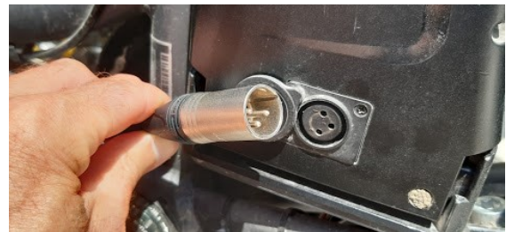
Bild 4: Schwierig kann die Suche nach dem passenden Stecker für den Akkumulator werden. In meinem Fall war es jedoch ein weit verbreiteter XLR-Stecker
