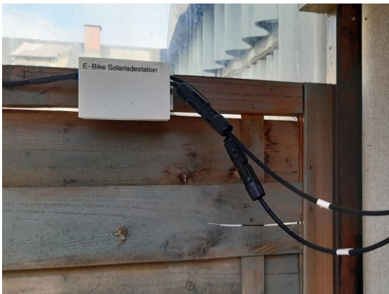
Bild 3: DC/DC-Wandler in 3D gedrucktem Gehäuse und mittels MC 4 Steckverbindung an das Solarpanel angeschlossen
