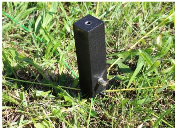
*Bild 14: Das Fußteil wird auf den Erdspieß aufgeschraubt und mit der Mutter fixiert*
