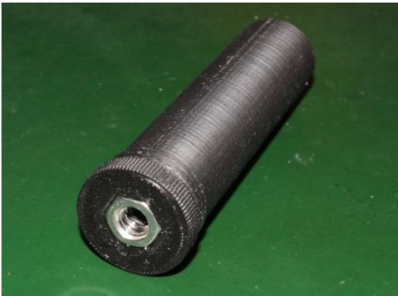
*Bild 3: Adapter (3D-Druckteil) mit eingeklebter Mutter M8*
