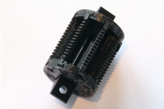
*Bild 9: Fertiger Spulenkörper (im Bild für das 30 m Band) nach der Montage und vor der Bewicklung mit Kupferlackdraht*
