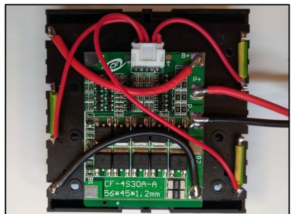
**Bild 4:** Nachdem das BMS an der Rückseite der Halterung befestigt ist, werden die Zu- und Steuerleitungen verkabelt
