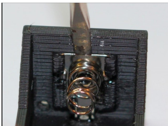
Bild 3: Der Batterieclip wird mit einem Schraubendreher in die Halterung gedrückt (hier an einer Halterung für einen Akku demonstriert)
