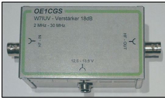
Bild 6: Fertiger und beschrifteter Vorverstärker
