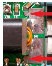
Bild 20: Die Lötstellen und die Bauteilbeschriftung für R6 sind bereits vorhanden, alleine der entsprechende Widerstand fehlt im Bausatz.
