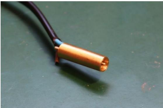
**Bild 6:** Die Spitze des Messingstabs muss beim Verkleben des Isolators bündig mit dem Messingrohr sein
