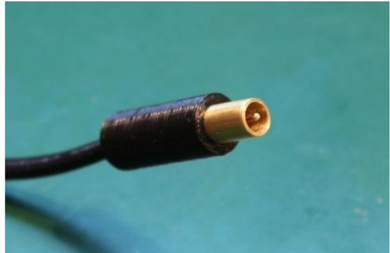
*Bild 10: Fertiger Ladestecker für den Xiaomi M365 E-Scooter*
