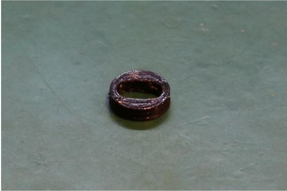
*Bild 8: Maßgeschneiderte Kabeldurchführung für den Stecker*
