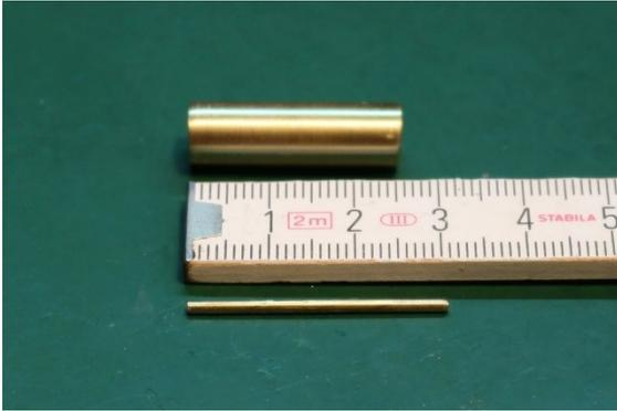
*Bild 2: Messingrohr (Außenleiter) und Messingstab (Innenleiter)*
