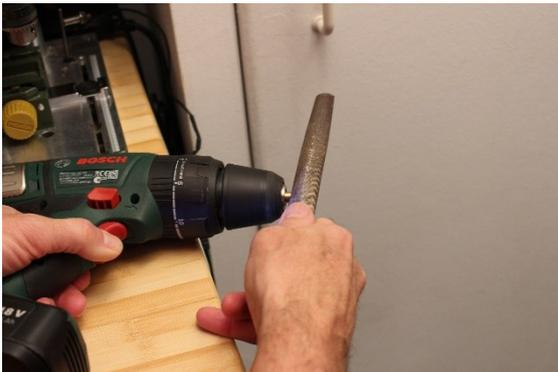
*Bild 3: Ersatzweise gelingt die Herstellung des passenden Durchmessers auch mit Bohrmaschine und Feile*
