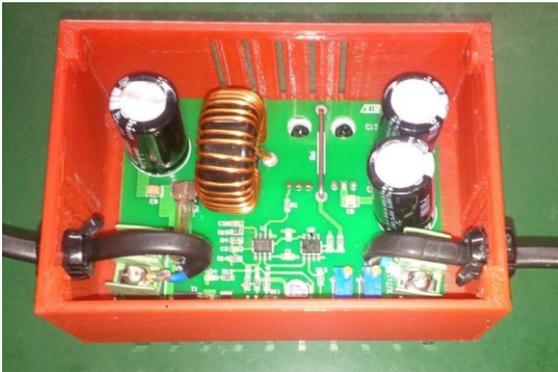
*Bild 2: Gehäuse mit montierter Platine vor der Montage des Deckels*
