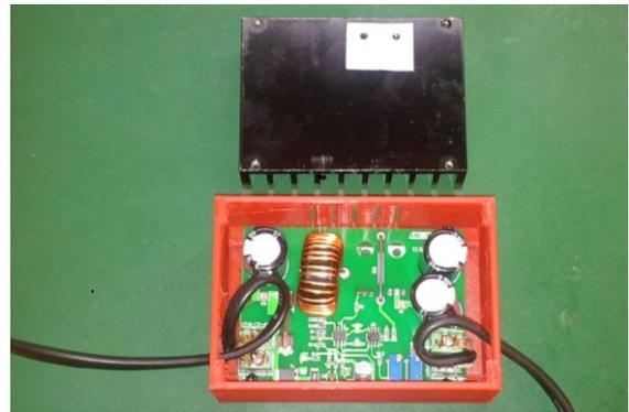
*Bild 1: Der demontierte Kühlkörper mit aufliegenden Isolatorplättchen und der untere Gehäuseteil samt Platine*
