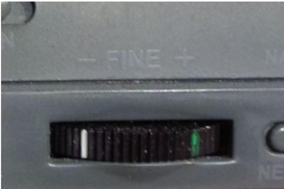
*Bild 2: Farbmarkierungen auf dem Einstellrad für die Frequenzablage erleichtern die Frequenzeinstellung*
