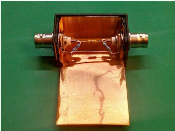
Bild 4: Fertig aufgebautes Dämpfungsglied vor dem Ankleben des Deckels
