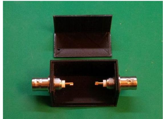
Bild 2: Montage der BNC-Buchsen im gedruckten Gehäuse
