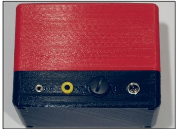
**Bild 4:** Rückseite mit den Anschlüssen (v.l.n.r.): Standby-Taster, Erdungsbuchse, Sicherungshalter, Versorgungsspannung
