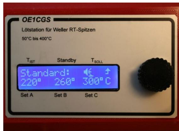
*Bild 7: Anzeige zur Einstellungen der Parameter. Diese erscheint, wenn während des Einschaltvorgangs der Lötstation der Drehschalter gedrückt gehalten wird.*
