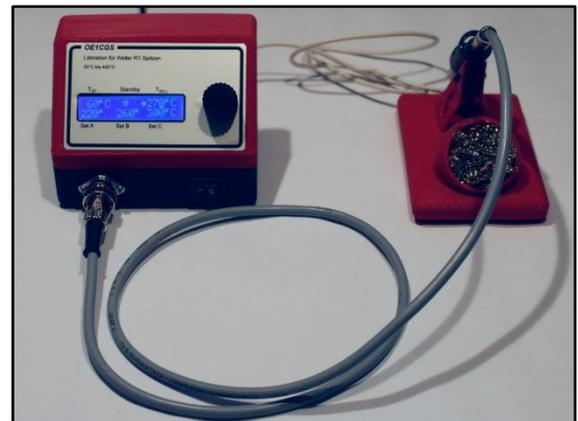
Bild 1: Digitale Lötstation inklusive Lötspitzenhalter
