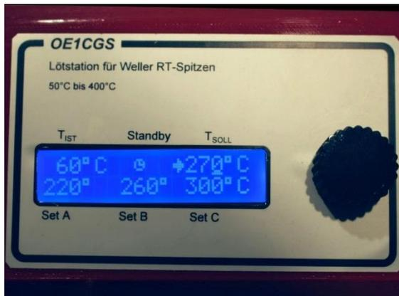
*Bild 6: Anzeige mit aktueller Temperatur und Solltemperatur, Standby-Indikator und einer Auswahl an frei konfigurierbaren Solltemperaturen*
