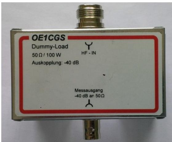
Bild 3: Beschriftung auf dem Gehäusedeckel
