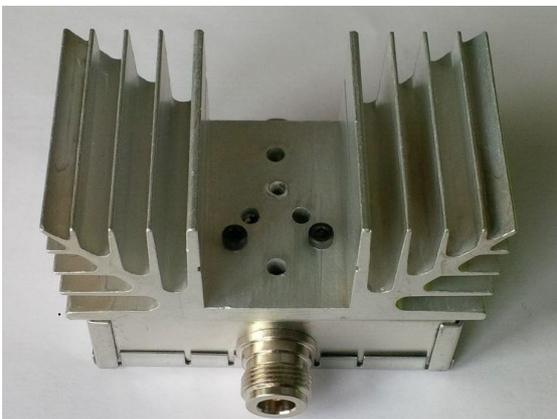
Bild 4: Fertige Dummy Load 100 W
