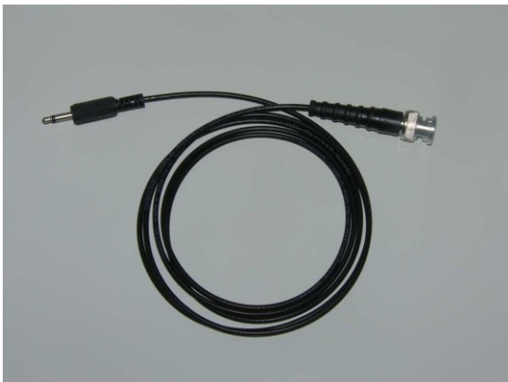
Bild 4: Fertiges, optimiertes Antennenkabel mit integrierter Impedanzanpassung
