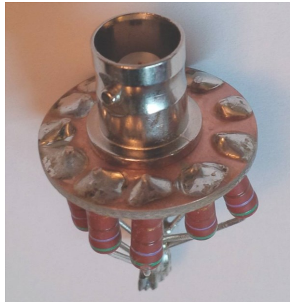
Bild 2: Mit BNC-Buchse und verlöteten Widerständen
