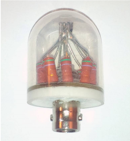
Bild 3: Fertige Dummy Load im Gehäuse
